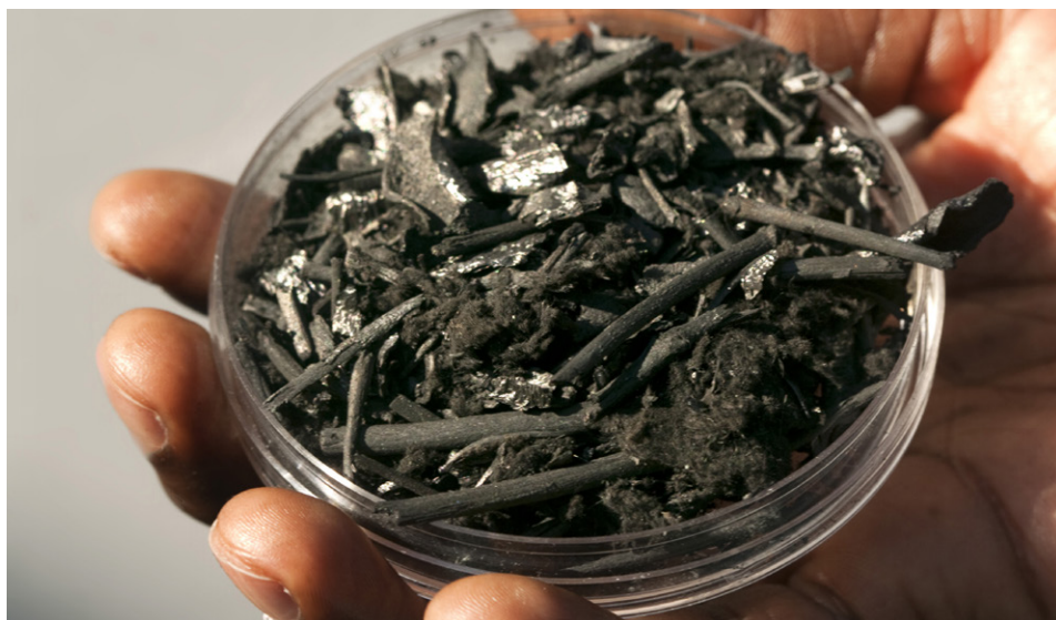
Rysunek 19. Biowęgiel, który dodaje się do gleby w celu uzyskania podłoża strukturalnego
