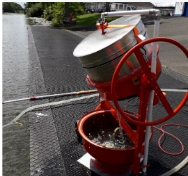
Probenahmeapparatur („RoSi“) der TU Berlin
