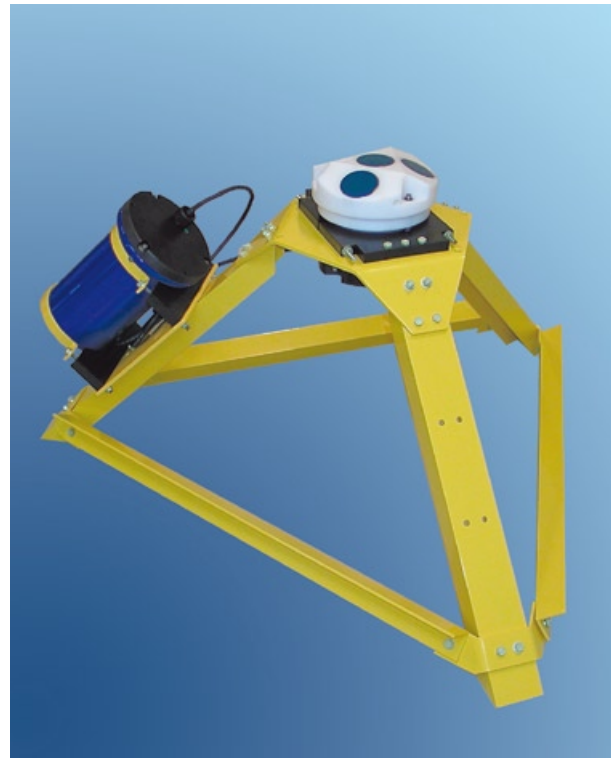
ADCP der Firma Nortek (Quelle: NORTEK AS)
